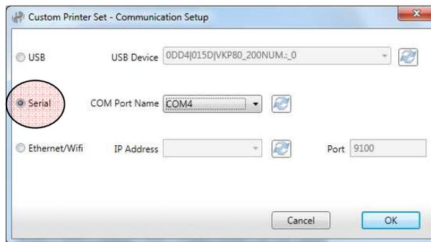
Рисунок 14 – Принтер подключен по RS232 (COM4).
