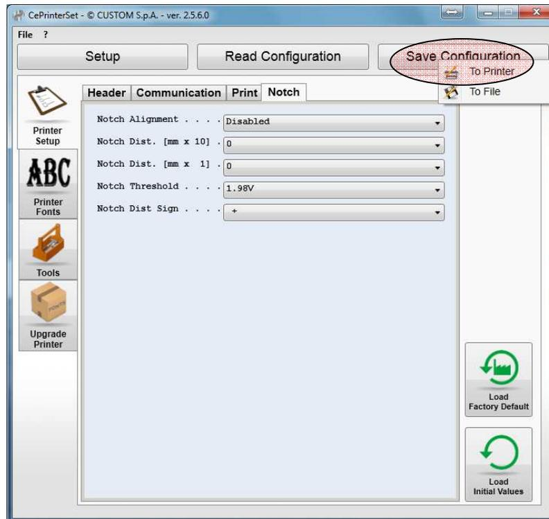
Рисунок 24 – Запись конфигурации в принтер
