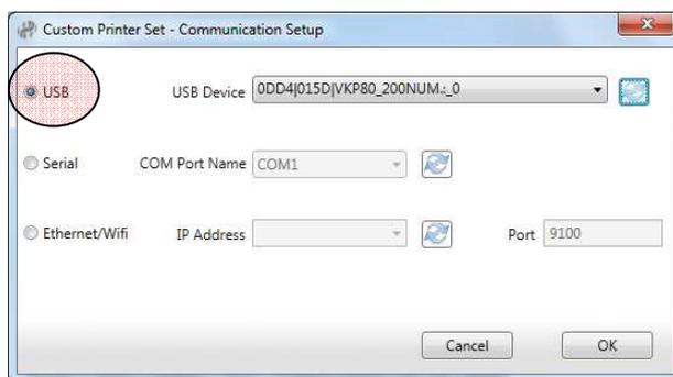
Рисунок 13 – Принтер подключен по USB.
